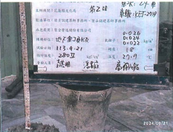
說明：設計坍度 15cm±4cm 實測 18cm 照片三
