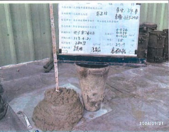
說明：設計坍度 15cm±4cm 實測 18cm 照片二
