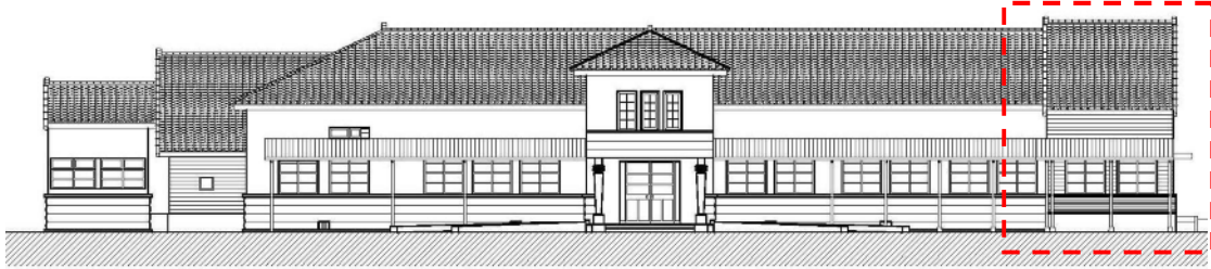
圖 3-51 前棟最南側的空間有三個屋架的尺寸特別大，也使得這部位的建築高度拉高，合理推測這部份空間應該也是後來因應空間不足所增建出來的。(本研究繪製)
