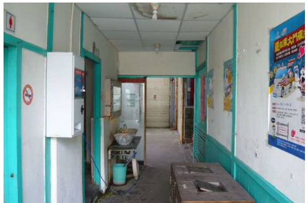
【圖 3-120】後棟採傳統日式「真壁造」作法
