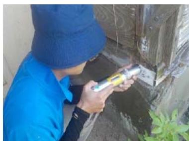
照片 5-1.4 以表面腐朽偵測儀量測腐朽情形
