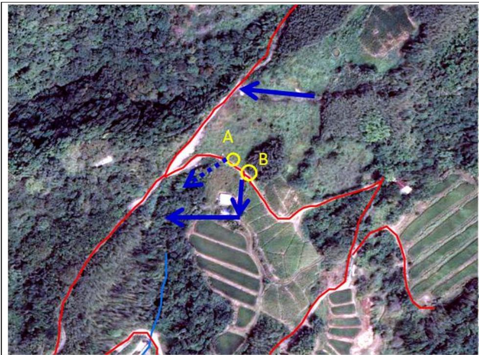
圖 3-11 宋啟源先生梯田上邊坡局部排水規劃情形
