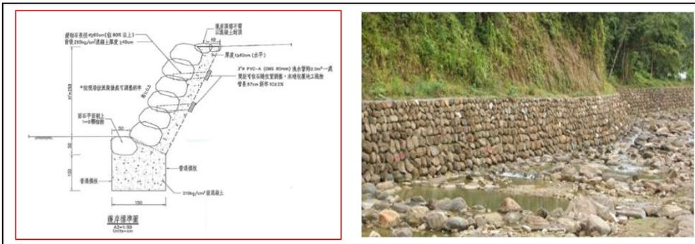
圖 3-15 多孔隙砌石護岸範例
